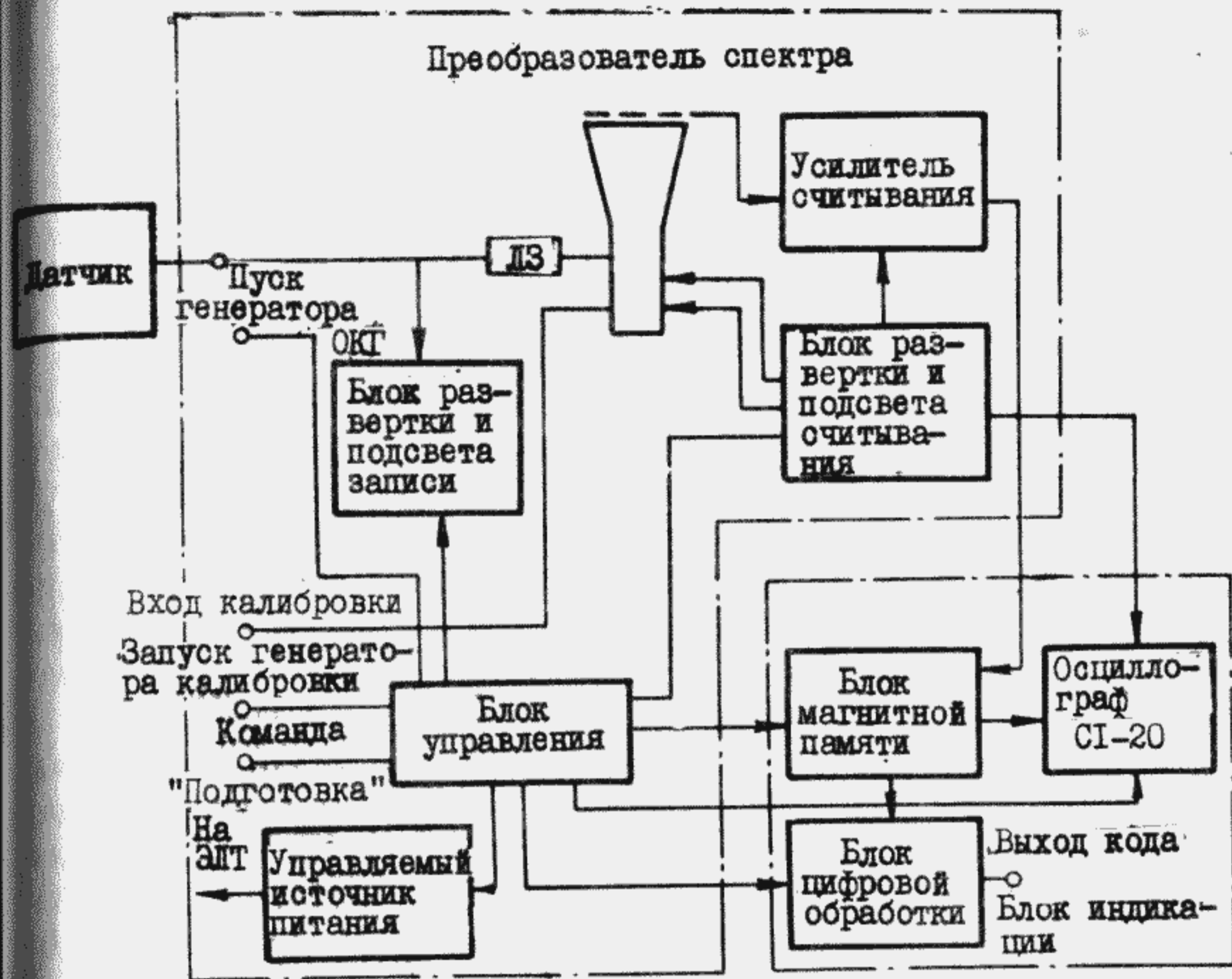
Рис.21. Структурная схема измерителя наносекундных импульсов ИНИ1
