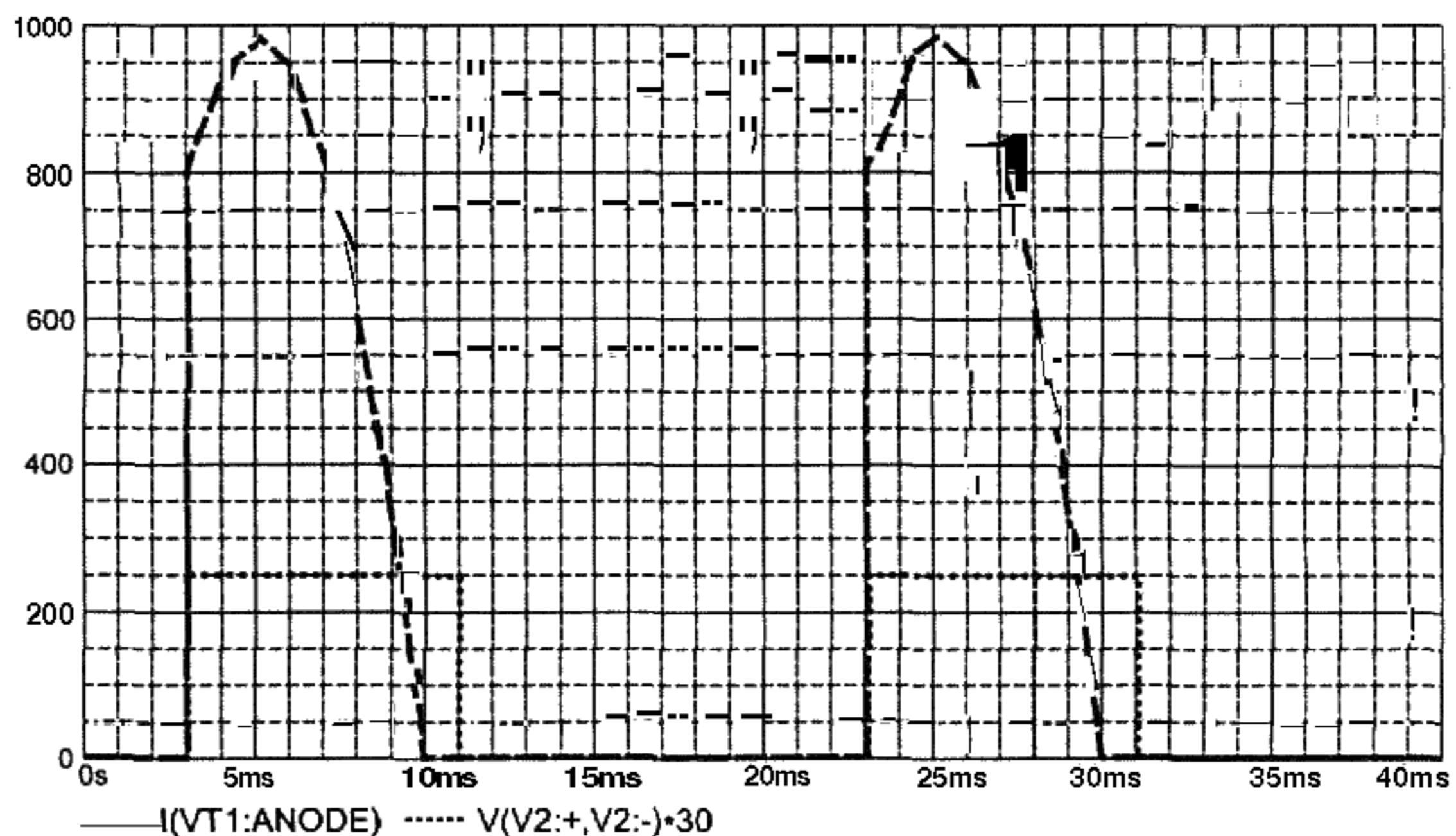
Рис. 5.3. Осциллограммы тока через тиристор и импульсов управления для случая, когда масштаб отображения импульсов управления искусственно увеличен для удобства работы
