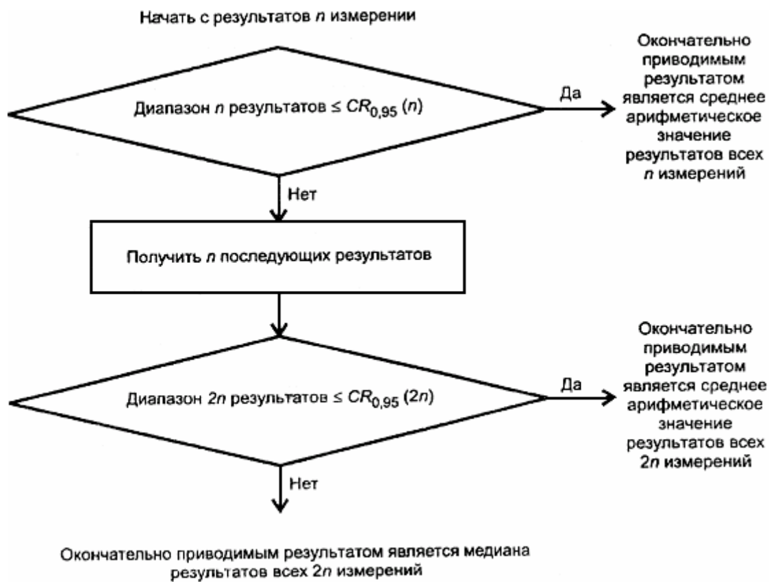
Рисунок 4 - Метод проверки приемлемости результатов измерений, полученных в условиях повторяемости, при первоначальном получении n результатов измерений и условии, что получение результатов измерений не является дорогостоящим (вариант А)
