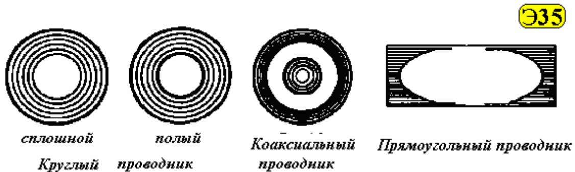
Распределения тока в проводниках различной конструкции из-за скин-эффекта
