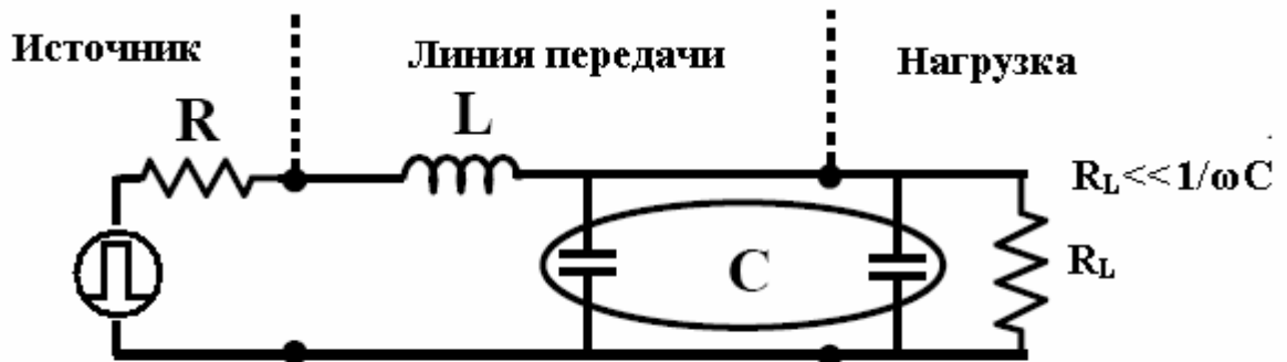
Эквивалентная схема импульсного источника, короткой линии передачи и нагрузки при высоких частотах
