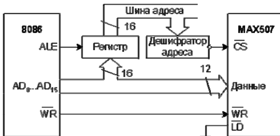
Рис. 16. Подключение ЦАП с параллельным интерфейсом к микропроцессору Intel 8086
