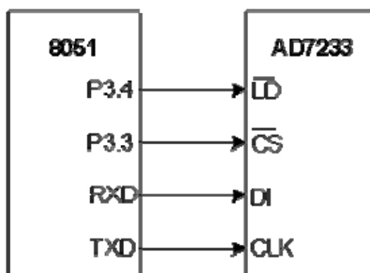
Рис. 14. Подключение ЦАП с последовательным интерфейсом к микроконтроллеру семейства MCS51
